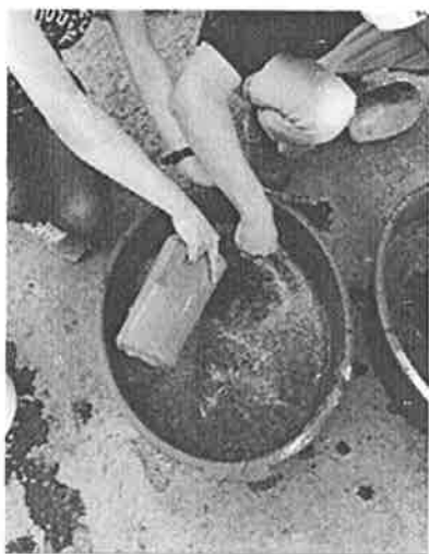
写真4：消石灰を振り入れ空気酸化を行う
